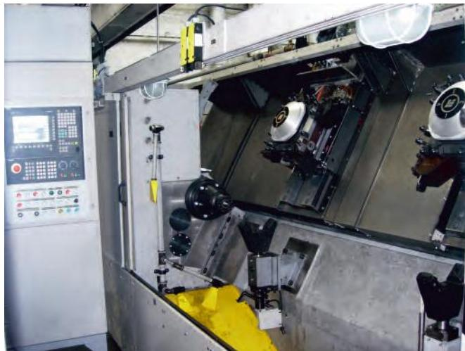
Модель СМ1712Ф3 представляет собой горизонтальный токарный станок с числовым программным управлением, предназначен для чистовой обработки оси вагонной.
