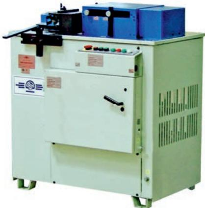
Машина гибочная универсальная предназначена для гибки труб, квадратных профилей, полосы, прутков, уголков, отрезки полосы, прутка, трубы, прошивки, скручивания, штамповки, вырубки различных материалов с усилием до 120кН(12т) в металлообработке. Наиболее эффективно применение машины при единичном и мелкосерийном производстве.
