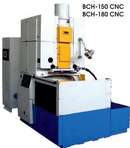
Зубодолбёжные полуавтоматы предназначены для нарезания прямозубых цилиндрических колёс внешнего и внутреннего зацепления дисковыми долблёками методом обката. Полуавтоматы имеют вертикальную компоновку.
