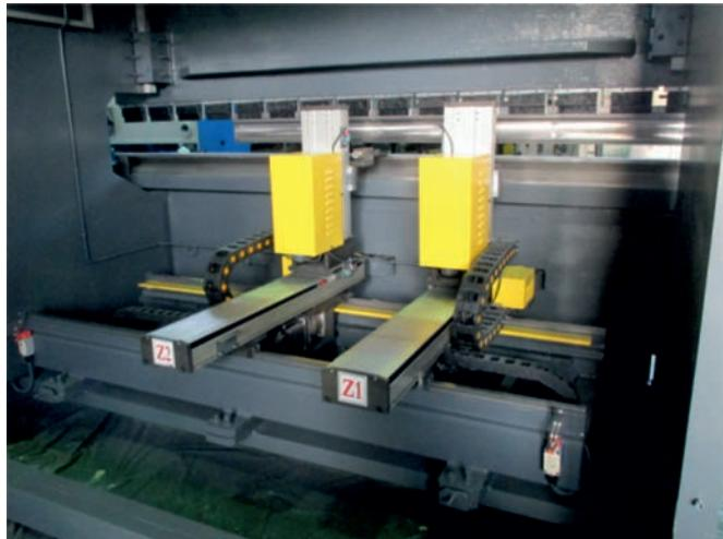
как недогиб или перегиб изделия, автоматически переставляет задние упоры на требуемые параметры по высоте, глубине и ширине. Система ЧПУ на листогибочном прессе отслеживает и управляет движением ползуна - по двум осям, движением задних упоров - по шести осям (при оснащении листогибочного пресса соответствующим задним упором), а также работой системы бомбирования (системы компенсации прогиба стола)-оси листогибочного пресса приведены на рисунке ниже.
