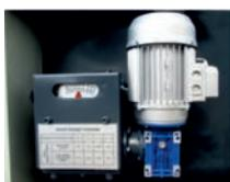
Механизм регулировки зазора между ножами с моторным приводом с выводом информации на градуированную шкалу.
