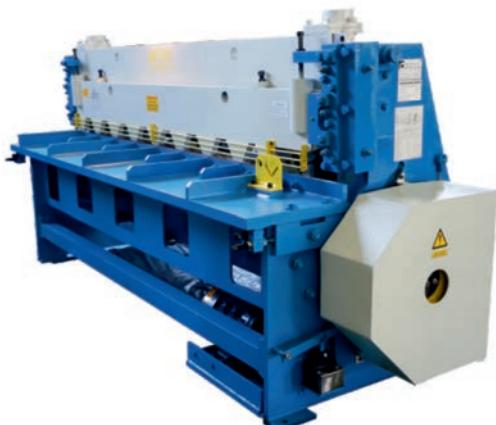
Ножницы листовые крикошипные с наклонным ножом предназначены для резки листового материала с пределом прочности до 450 МПа (45кгс/мм<sup>2</sup>) толщиной от 4 мм до 20 мм, диной резания до 2500 мм. Некоторые модели оснащены возможностью резки профильного проката: круглого прутка диаметром до 35 мм и уголка равнополочного размером до 63х63х6 мм.
