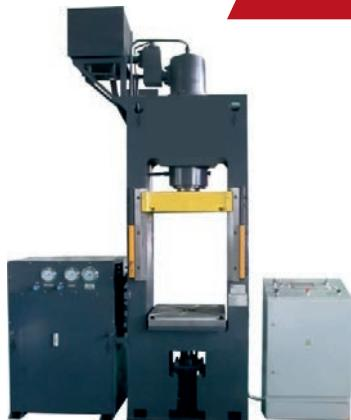
Данные прессы используют для формования изделий из реактопластов методами прямого и литьевого прессования, изготовления изделий из резины, неметаллических материалов, а также изделий из тонколистового металла.
