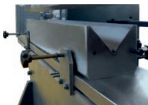
Нестандартный инструмент (матрица) для гибки стали 09Г2С толщиной 25 мм.
