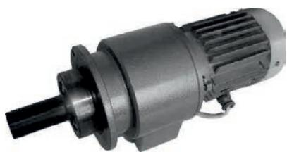
Головка электромеханическая 7921-0003 предназначена для механизированного зажима инструмента в шпинделах фрезерных станков, а также может быть применена в качестве привода с односторонним вращением выходного вала, для получения малого числа оборотов исполнительного механизма при максимальном крутящем моменте.
