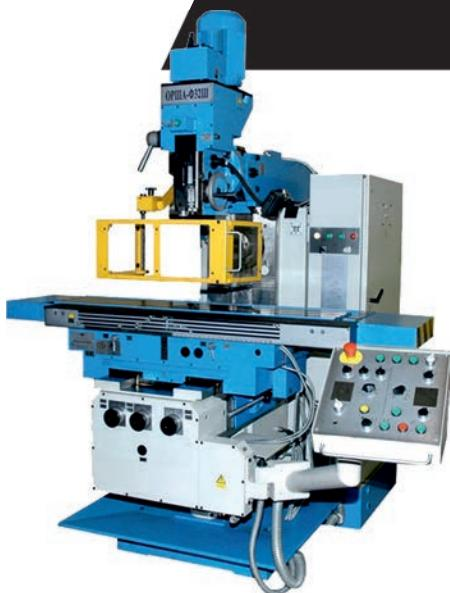
Станок предназначен для фрезерования плоских и фасонных поверхностей всеми видами фрез. Станок имеет горизонтальный фрезерный шпиндель с конусом ISO-50. На широкоуниверсальном станке используется поворотная в двух плоскостях вертикальная фрезерная головка со шпинделем ISO-40. Головка установлена на ползуне и имеет автономный привод.
