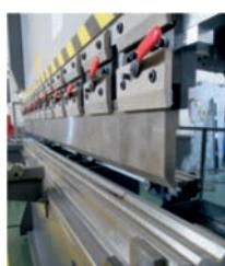
Стандартный инструмент (матрица и пuhanсон). Быстро съемная система крепления.
