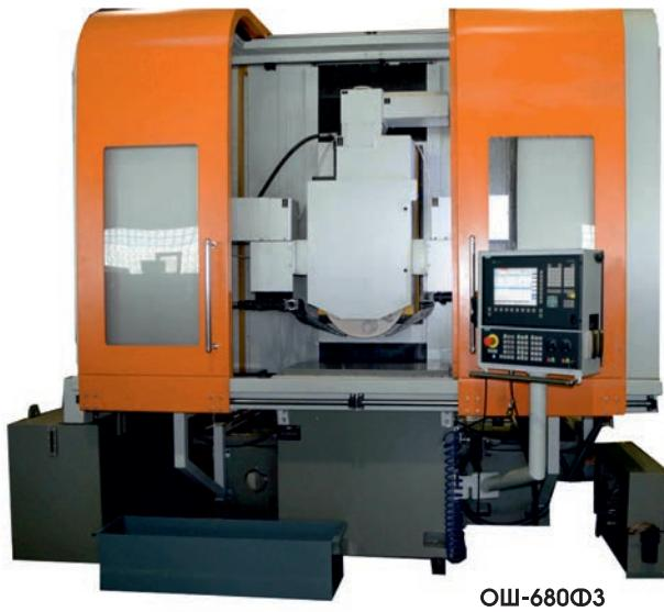
Станок специальный для глубинного профильного шлифования с ЧПУ ОШ-680 предназначен для глубинного шлифования абразивными шлифовальными кругами профильных прецизионных поверхностей лопаток газотурбинных двигателей, изготовленных из жаропрочных и других труднообрабатываемых материалов.
