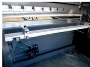
Моторизированный задний упор (800 мм; 1000 мм, ШВП).
