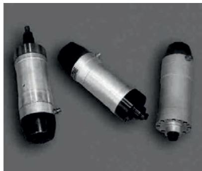
Головки ЭМГ предназначены для механизированного зажима инструмента в шпинделах фрезерных, расточных и других станков, привода кулачков токарных патронов, перемещения пинолей задних бабок. Головки могут встраиваться как во вновь создаваемое оборудование, так и при модернизации действующих станков.
