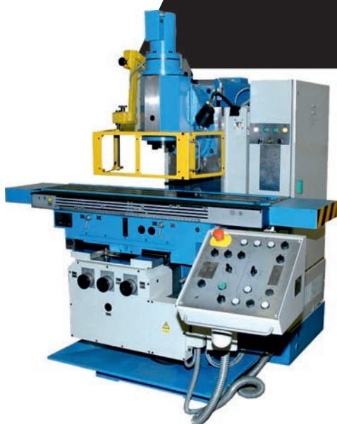
Станок предназначен для фрезерования плоских и фасонных поверхностей всеми видами фрез. Станок имеет горизонтальный фрезерный шпиндель с конусом ISO-50. На универсальном станке используется съемная, поворотная в плоскости, перпендикулярной оси горизонтального шпинделя, вертикальная фрезерная головка со шпинделем ISO-50, приводимая в движение от горизонтального шпинделя.
