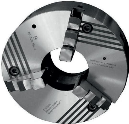
Патроны предназначены для установки на токарных универсальных и специальных станках.
