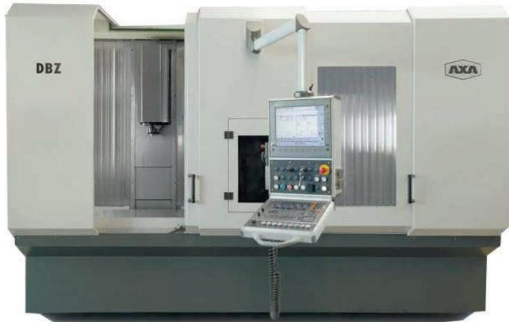
DBZ (Обрабатывающий центр с двумя рабочими зонами) - это небольшой обрабатывающий центр с двумя отдельными рабочими зонами. Челночный принцип обработки позволяет производить загрузку одной зоны во время работы другой.
