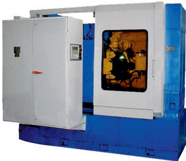
Станок зубофрезерный с вертикальной осью изделия предназначен для обработки прямозубых и косозубых колёс, звёздочек, червячных колёс червячными фрезами методом обката.
