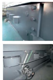
Система компенсации прогиба рабочего стола, бомбирование (регулируется вручную или от ЧПУ).
