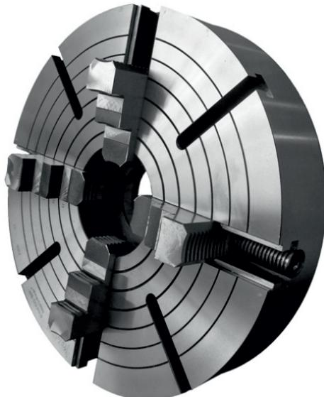
Патроны соответствуют ГОСТ 3890, предназначены для зажима и обработки пруткового материала и штучных заготовок сложной конфигурации, несимметричных, эксцентрических (отливки, поковки и т.п.) на станках токарной группы.
