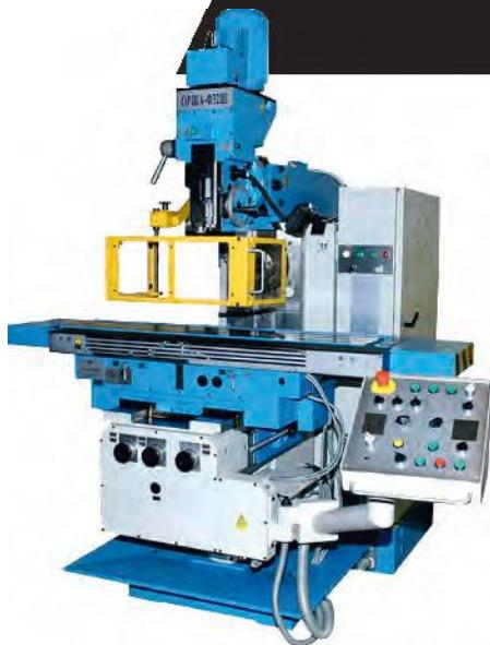
Станок предназначен для фрезерования плоских и фасонных поверхностей всеми видами фрез. Станок имеет горизонтальный фрезерный шпиндель с конусом ISO-50. На широкоуниверсальном станке используется поворотная в двух плоскостях вертикальная фрезерная головка со шпинделем ISO-40. Головка установлена на ползуне и имеет автономный привод.
