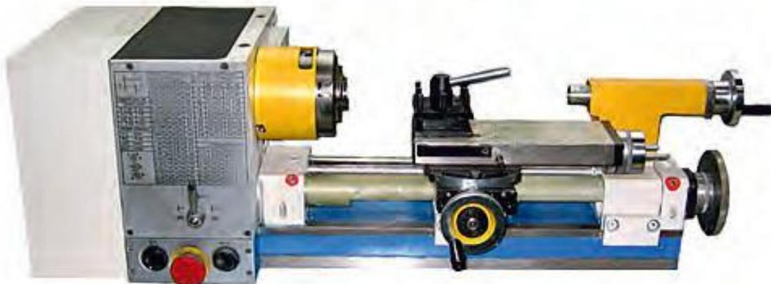
Станок ВСТ-028 универсальный токарный настольный предназначен для выполнения различных видов работ по металлу: наружного и внутреннего точения, нарезания правой и левой резьб, фрезерования, сверления. Для индивидуальных потребителей, связанных с обработкой металла.
