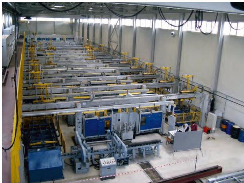
Комплекс оборудования для полной механической обработки вагонных осей состоит из предлинейного, ленточно-пильного комплекса, автоматической линии для токарной обработки и обработки отверстий, автоматической линии для накатной и шлифовальной обработки. Во вторую линию входит комплекс неразрушающего контроля обработанных осей. Состав оборудования обеспечивает соблюдение типового технологического процесса обработки вагонных осей.
