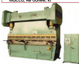
Прессы листогибочные кривошипные предназначены для изготовления деталей из листового и полосового проката методом гибки.
