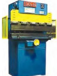
Прессы листогибочные пневматические предназначены для изготовления деталей из листового и полосового проката методом гибки.
