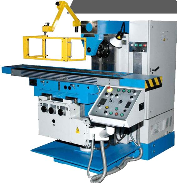
Станок предназначен для фрезерования плоских и фасонных поверхностей всеми видами фрез. Станок имеет горизонтальный фрезерный шпиндель с конусом ISO-50.
